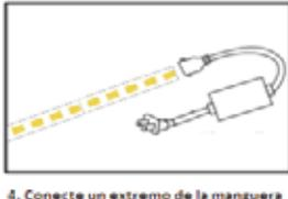
4. Conecte un extremo de la manguera al conector /controlador, recordando que cualquier manguera de LED debe alimentarse por un extremo en particular (el mas extremo del carrete) asegúrese que la manguera quede bien sujeta al conector para garantizar su correcto funcionamiento.
