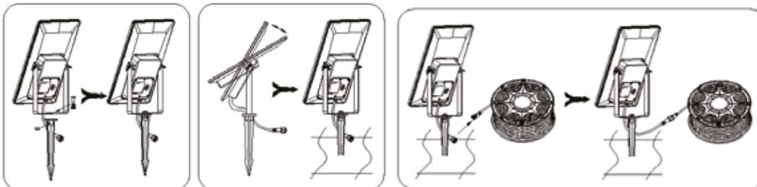
1.0 Fija la estaca del piso a la cercha, pon la tuerca y aprieta hasta quedar fija.
