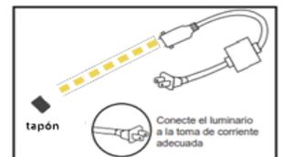
6. Coloque un tapón en el extremo final de lamanguera, se recomienda auxiliar la fijación del mismo con cinta y termofit
