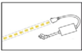
4. Conecte un extremo de la manguera al conector/controlador, recordando que cualquier manguera de LED debe alimentarse por un extremo en particular (el mas extremo del carrete) asegúrese que la manguera quede bien sujeta al conector para garantizar su correcto funcionamiento.
